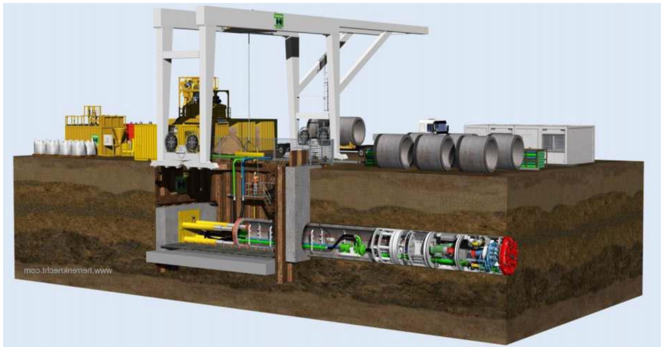
Фигура 10.2 Презентация на технологичния процес на микротунелно изграждане
